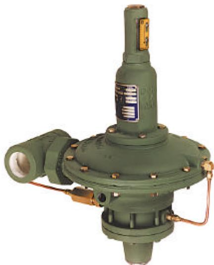
El fundamento para la amplia difusión del regulador *doma 99* es básicamente su compacto diseño, fácil instalación y simple mantenimiento: la válvula puede ser desarmada íntegramente sin desmontar el cuerpo de la cañería y puede instalarse en cualquier posición. No posee ningún tipo de venteo a la atmósfera y sus pilotos posibilitan una regulación precisa y estable.
